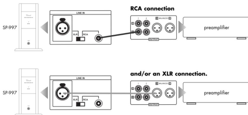
При наличии двух предварительных усилителей с выходами RCA и XLR их можно подключить к SP-995 и коммутировать (выбирать) активное соединение с помощью кнопки "XLR IN" на передней панели. Перед любыми переключениями входов не забудьте установить уровень выхода предусилителя на минимум.
