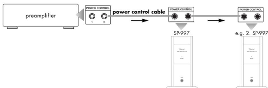
В теории число устройств, соединенных по шине триггерного управления не ограничено, и если проводное управление включением/выключением требуется расширить, то можно использовать соединение по цепочке через выходные разъемы Power Control объединенных шиной управления устройств. Метод, когда каждое устройство получает сигнал на триггерный вход и передает его дальше на выходной разъем шины управления, называется "daisy chaining" (последовательная цепь).
