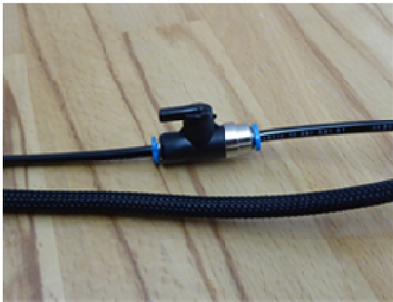
Fig. 13. Air flow- open
