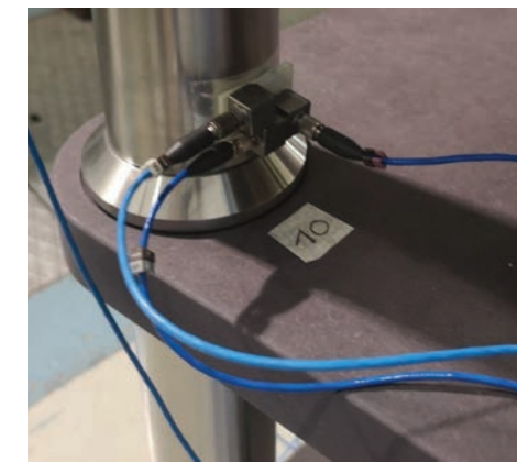
Golia durante le prove di analisi modale - Zoom di installazione su punto 10
