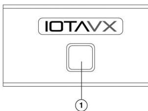
1. Кнопка ON/STANDBY на передней панели служит для включения и выключения устройства. Состояние усилителя определяется с помощью светодиодного индикатора: при включении устройства с помощью кнопки питания индикатор загорается белым цветом.
